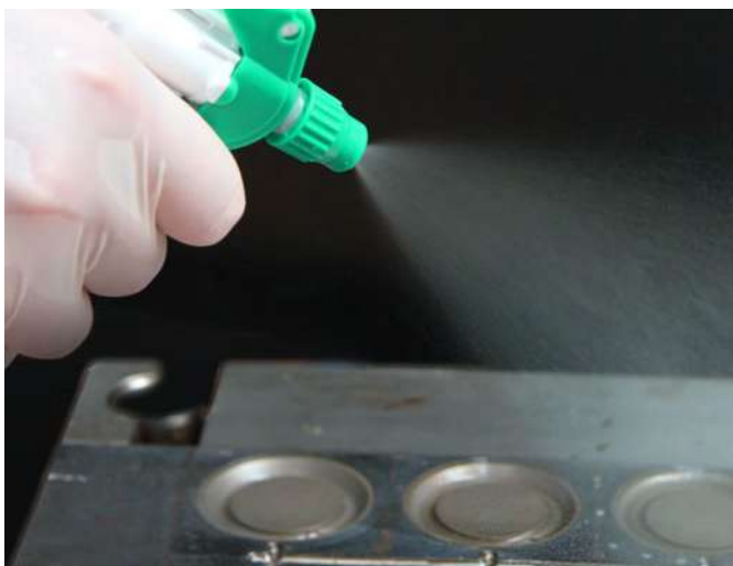
Manuelle Reinigung von Kunststoffspritzguss-Werkzeug
