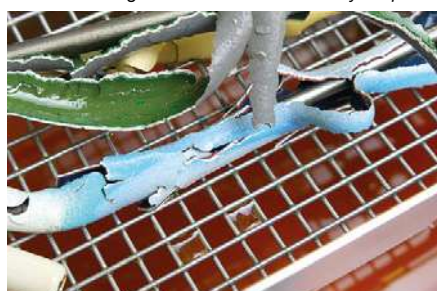
Lackentfernung im Ultraschallbad mit Poly Strip 100
