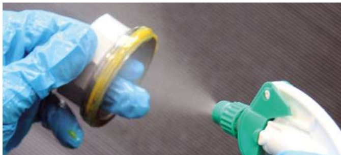
Dichtungsmasse entfernen mit GS 200
