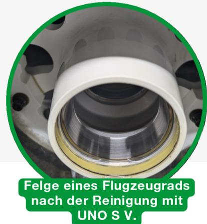
Felge eines Flugzeugrads nach der Reinigung mit UNO S V.
