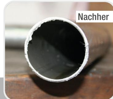
Effiziente Rohrreinigung mit starken Kalkablagerungen dank unserem RWR-System in Kombination mit POWER CLEANER DB.
