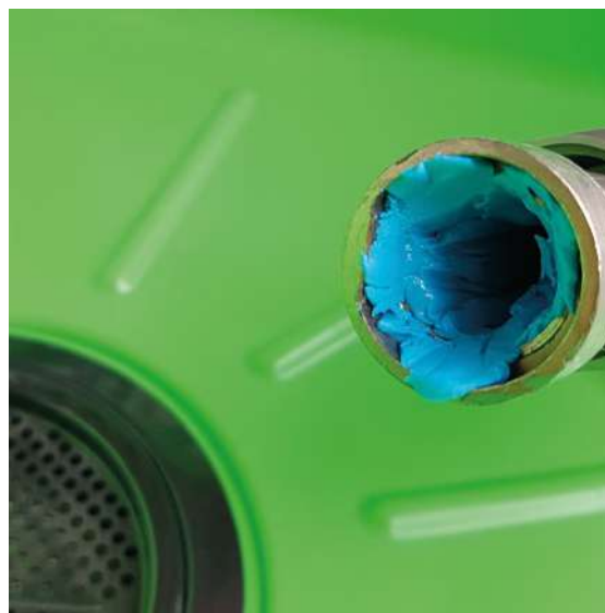
Wärmeleitpaste entfernen mit GS 200
