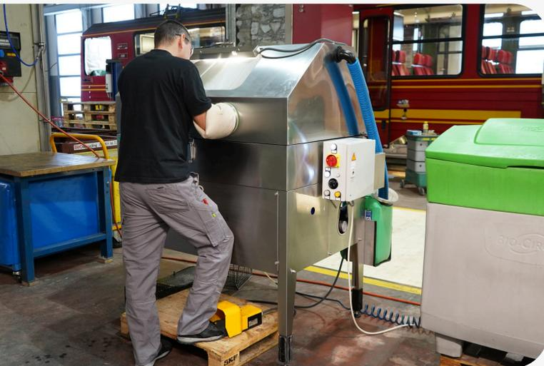
Avec le nettoyeur haute pression BIO-CIRCLE HP Vigo et le produit de nettoyage aqueux CB 100, les grandes pièces sales avec produit d'étanchéité peuvent être nettoyées efficacement. La haute pression permet de retirer le produit d'étanchéité sans endommager les pièces. Cela prolonge la durée de vie des pièces.
