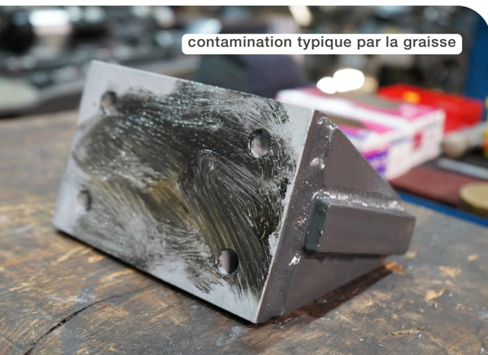
contamination typique par la graisse
