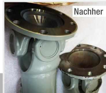
Mit unserem Schauminjektor in Kombination mit UNO AV gereinigter Stossdämpfer eines Strassenbahnchassis.
